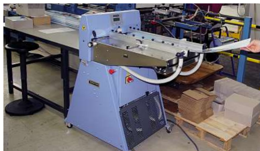
Seit April 2011 im Einsatz: Die R50 von Binderhaus beherrscht Nuten, Rillen, Perforation und Mikroperforation.
