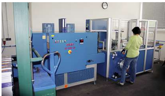
Mit der BVM-Folienverschweißmaschine werden bei Nagl Mailings optimal für den Versand verpackt.
